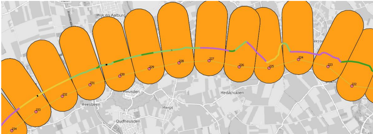
Figuur 16 Selectie per rivierkilometer van het dijkvak op de rechteroever met het slechtste toetsoordeel binnen een zone van 1km breed en 2km vanaf de rivieras.
